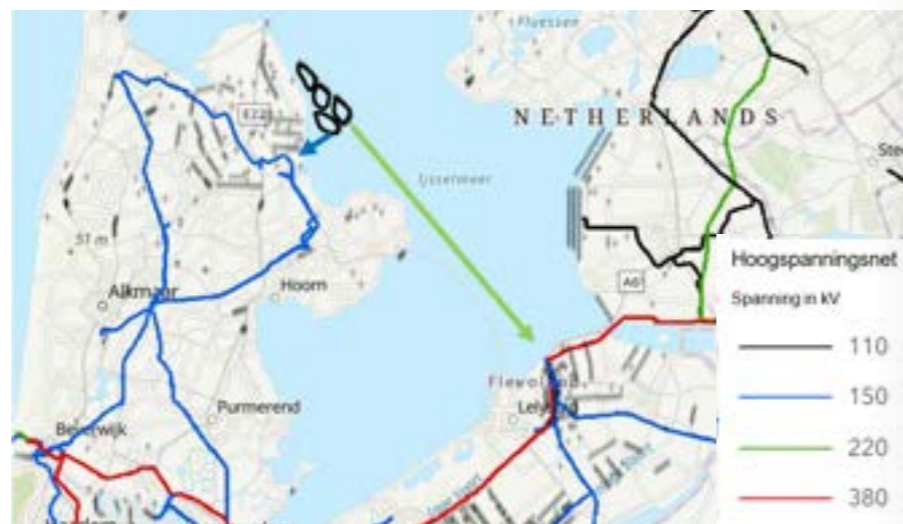
Fig. 6.5: Door middel van ondergrondse kabels sluiten we fase 1 aan in Noord-Holland en de hoofdaansluiting gaat ondergronds naar de Maximacentrale in Flevoland
